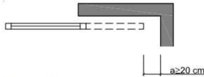
Figura 2.1 Holgura para evitar atrapamientos
