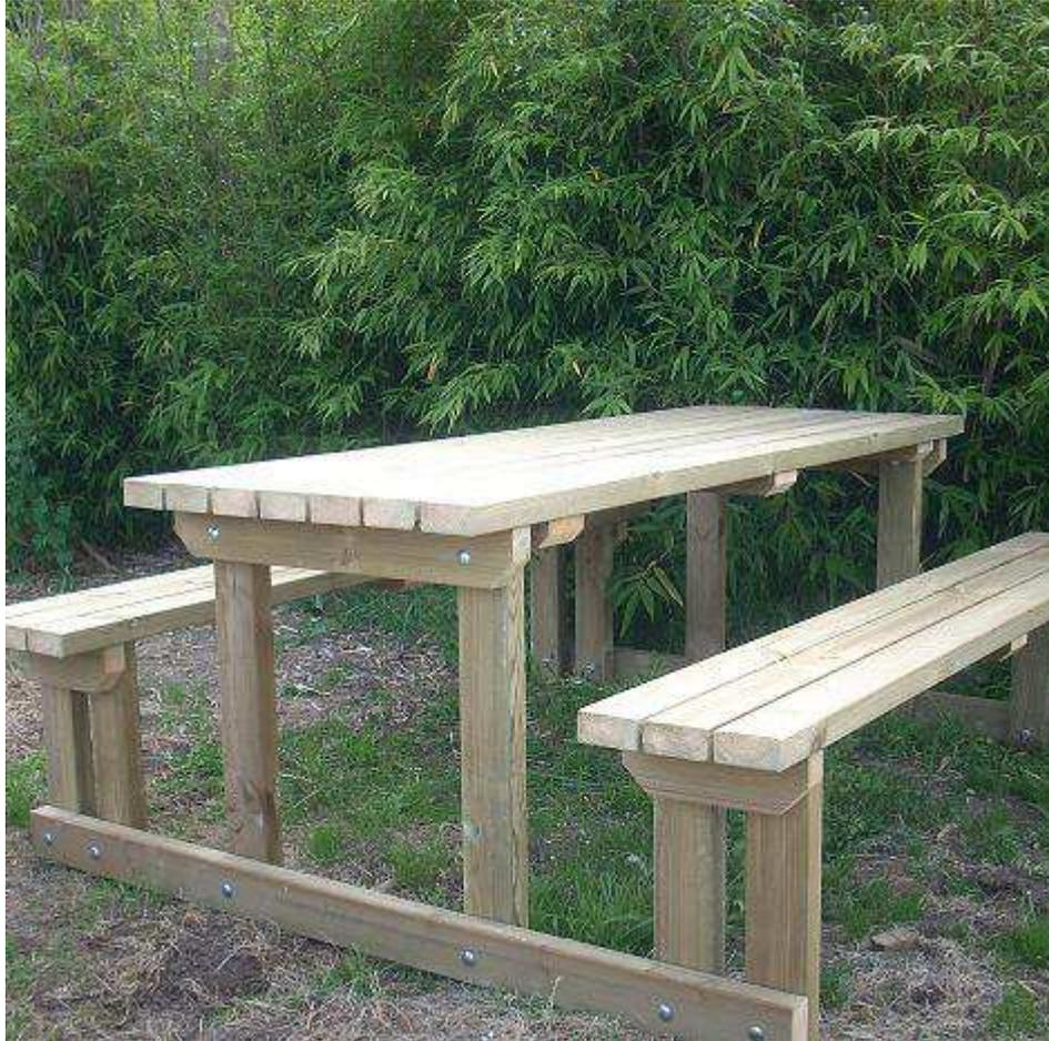
Mesa de madera de pino rojo de 4,5cm tratada para clase de riesgo IV. Lasurado final color nogal. Longitud 2 m. Ancho del tablero 70cm Espesor de la tabla 4,5 cm atornillados por arriba con tirafondos.
